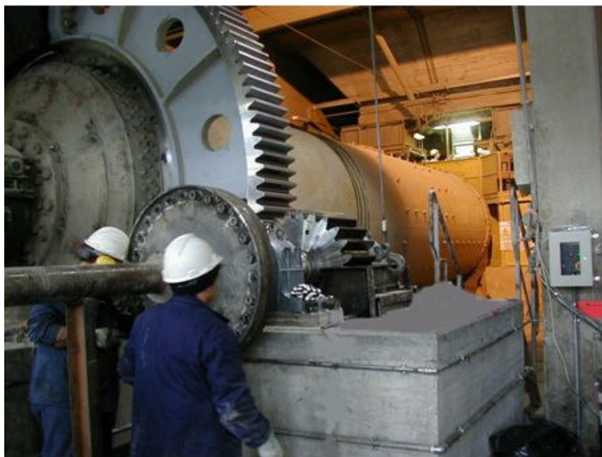
Fig. N°6 – Grande corona e pignone in funzione in un cementificio
